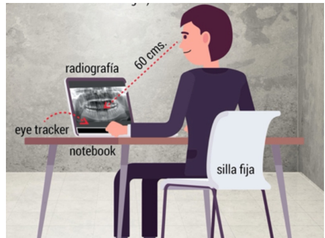
Figura 2. Esquema de distribución de elementos durante la evaluación de los observadores y las ortopantomografías, sincronizado al equipo eye tracker.
