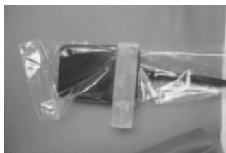
Figura 7 Sensor con su barrera biológica y su soporte.
